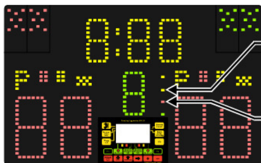
15. Ábra: Ethernet kapcsolatot jelző lámpák
